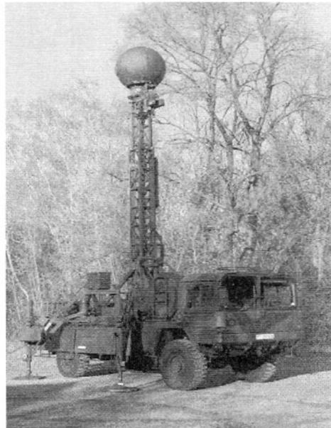
**Das Antennenfahrzeug** dient als Verbindungsglied zwischen BKS und Drohne.
