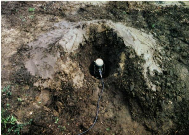
Schallmessmikrofon im Erdloch
